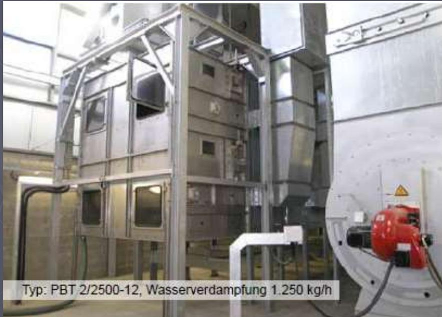
Typ: PBT 2/2500-12, Wasserverdampfung 1.250 kg/h
